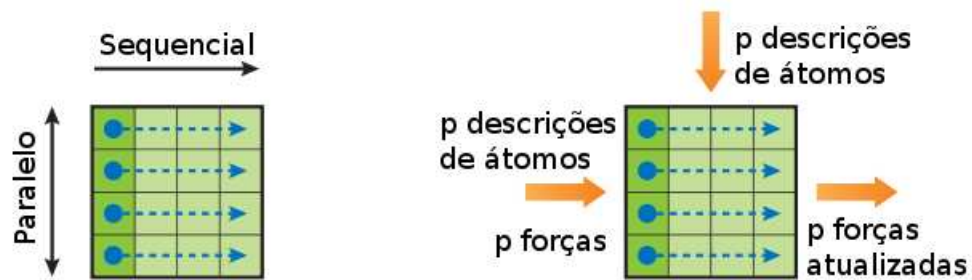
Figura 4.7: Esquema de um tile computacional. Linhas são calculadas em paralelo, mas cada linha é avaliada sequencialmente por uma thread CUDA (NYLAND; HARRIS; PRINS, 2006).
