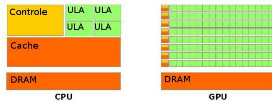
Figura 4.3: Comparação das estruturas internas entre GPU e CPU : A GPU dedica mais transistors ao processamento de dados (NVIDIA, 2009).
