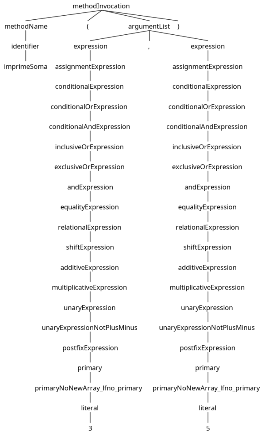
Figura 2.3: Exemplo de Árvore de Análise Sintática
