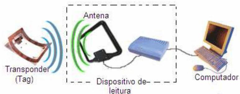
Figura 4 Composição Básica de um sistema de identificação de RFID [9].
