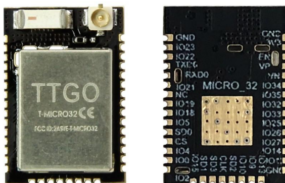
Figura 4: TTGO Micro-32 V2.0, o menor módulo encontrado portador do microcontrolador ESP32, com 13mm x 18,9mm x 5mm (Comprimento x Largura x Altura)
