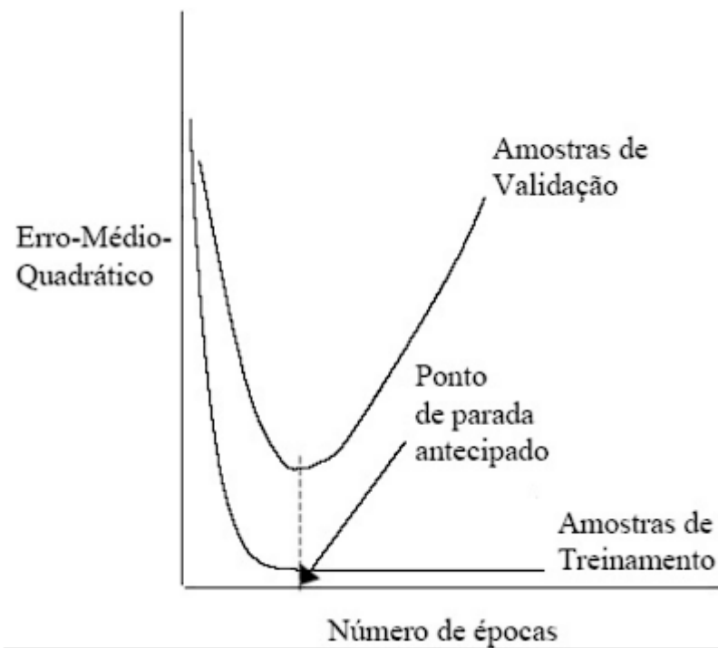
Figura 2.6: Análise dos erros de validação e treinamento ocasionando um ponto de parada antecipado durante o treinamento da rede neural (HAYKIN, 2001).
