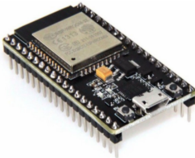
Figura 5.1: Módulo ESP32s de 38 pinos
