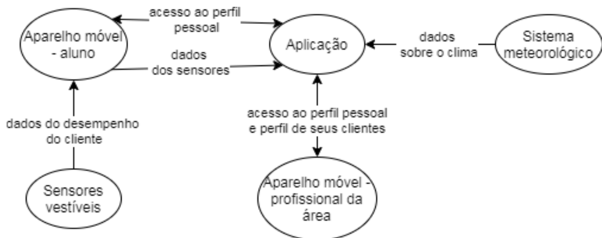
Figura 4.3: Diagrama de fluxo do cenário alternativo; neste, a aplicação é alimentada por dados fornecidos por um sistema meteorológico.
