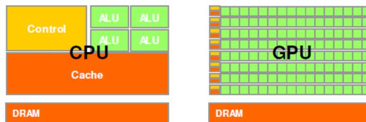
Figura 10: Comparação entre componentes de uma CPU e de uma GPU.
