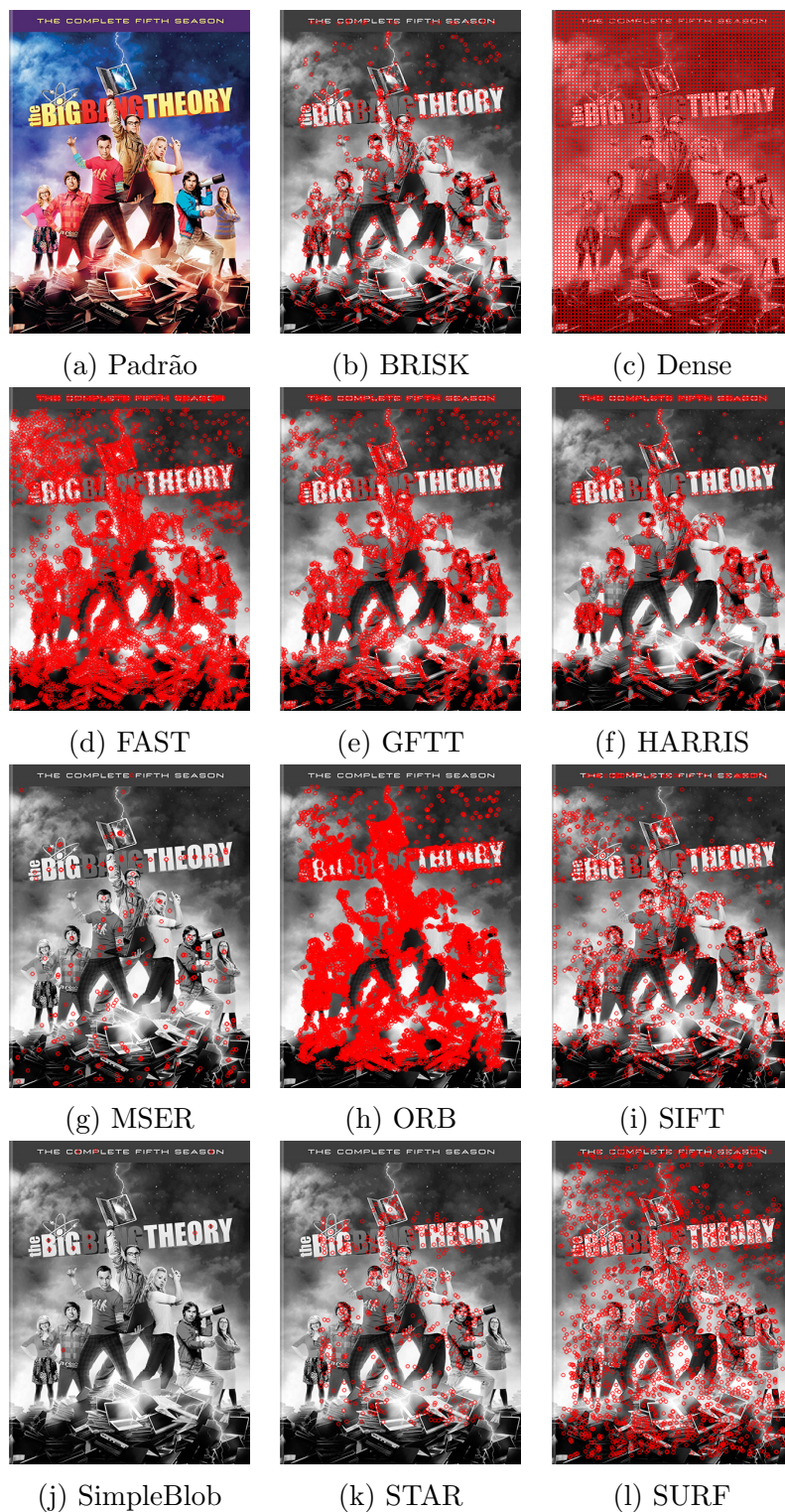
Figura 4.1: Distribuição dos pontos de interesse para cada algoritmo de detecção de características na imagem padrão.
