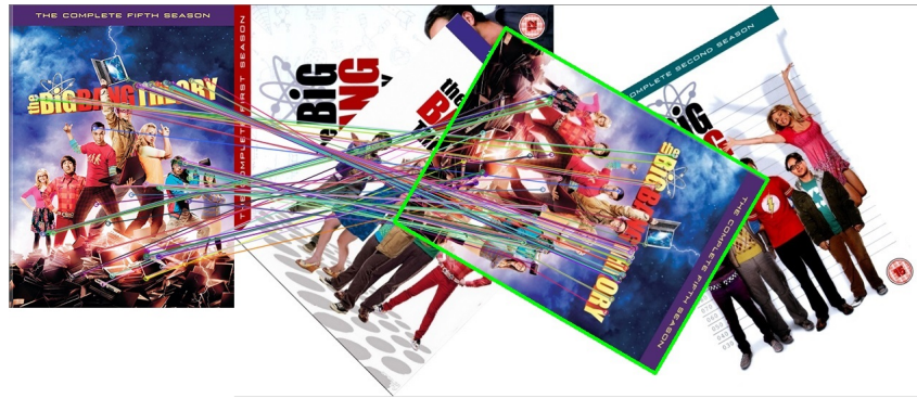
Figura 4.2: Exemplo de correspondência de uma imagem padrão (a esquerda) em uma imagem teste
