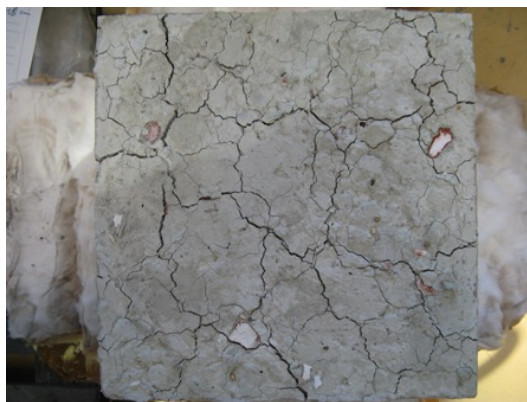
Figura 3.8: Superfície que ficou diretamente exposta ao aquecimento do CC-750
