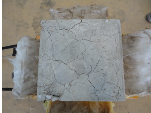
Figura 3.5: Superfície que ficou diretamente exposta ao aquecimento do CC-600
