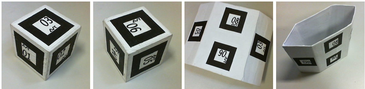
Figura 4.1: Configurações de marcadores utilizadas neste trabalho. As duas à esquerda mostram a configuração sobre uma base cúbica. As duas à direita mostram a configuração sobre um tipo de cilindro hexagonal irregular
