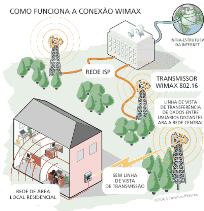
Figura 3.1: Funcionamento de uma conexão WiMax [4].
