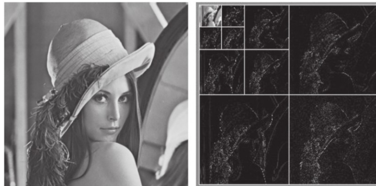
Figura 2.7: Exemplo de aplicação da DTW (Luo, 2008)
