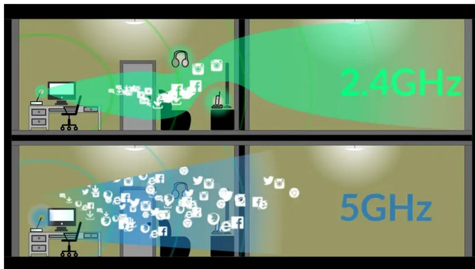
Figura 2.1: Diferenças entre Wi-Fi 2,4 GHz e 5 GHz.
