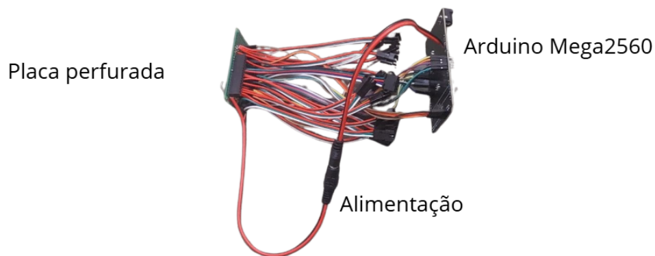
Figura 4.15: Foto da montagem da placa Arduino e placa perfurada.
