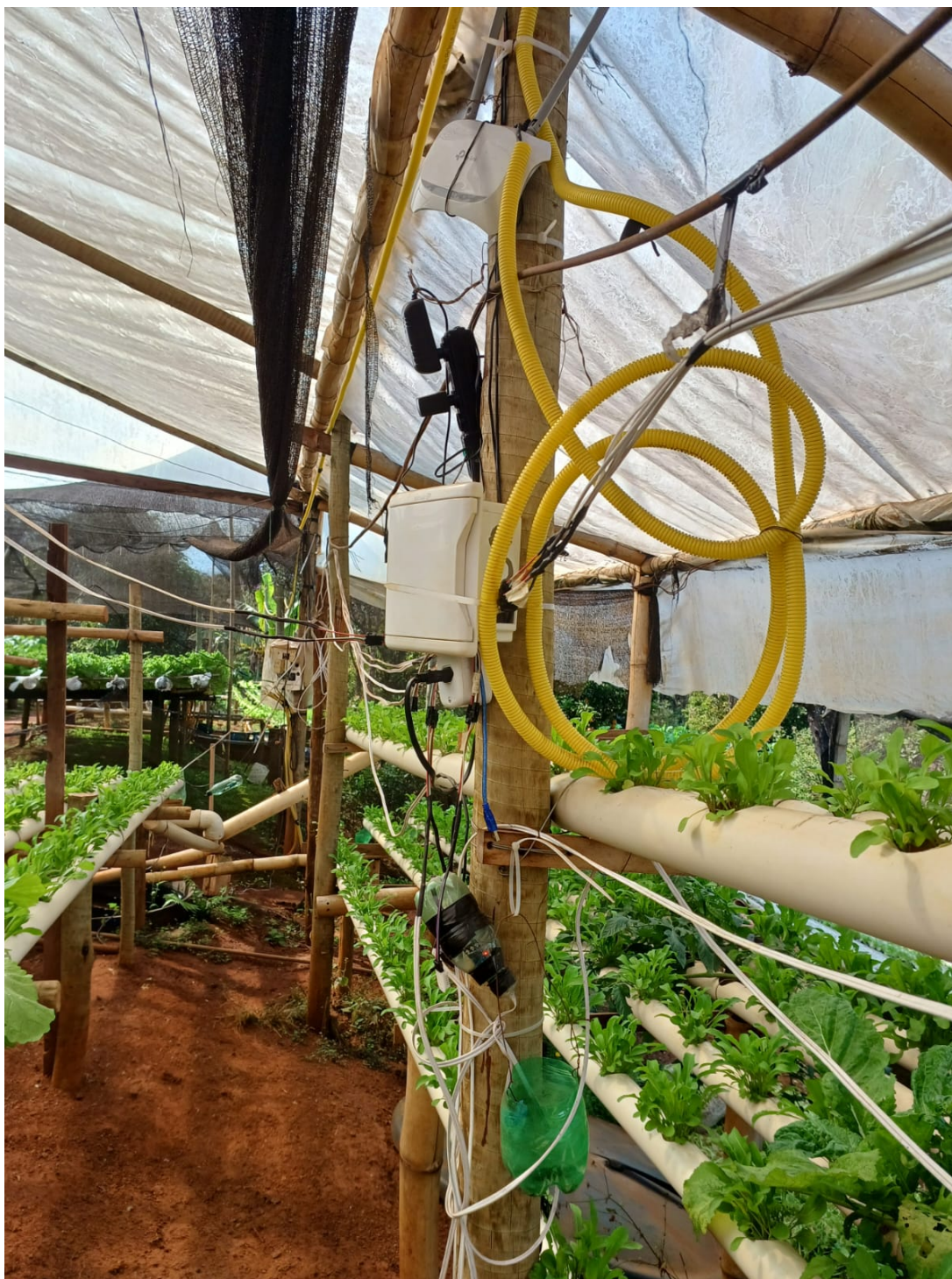
Figura 2: Detalhe da caixa de proteção contendo a placa de controle e o roteador, com os cabos conectados aos sensores distribuídos pelas bancadas.
