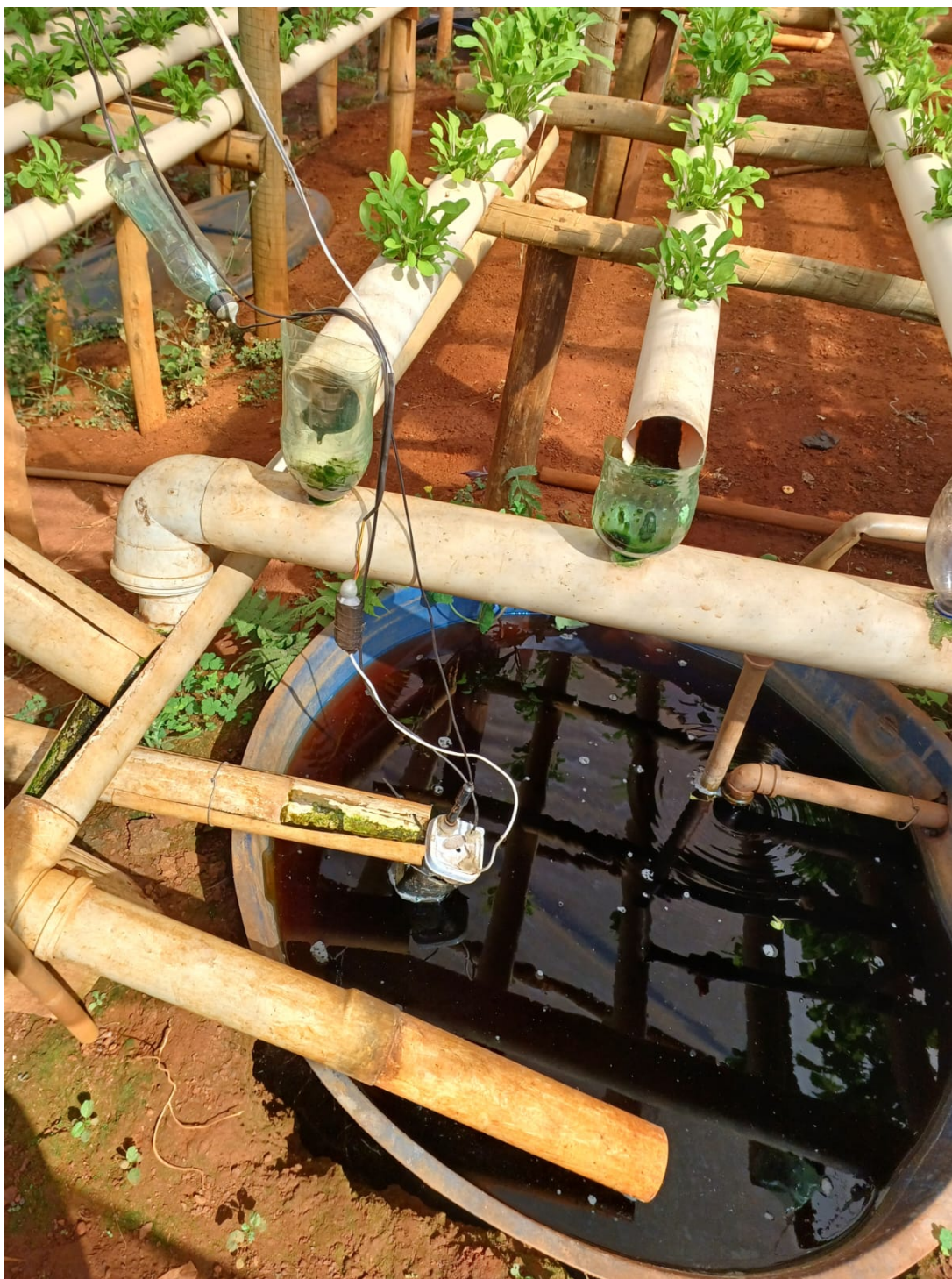
Figura 8: Visão geral do reservatório 1 contendo sensores de nível, temperatura, pH e condutividade elétrica da solução nutritiva.
